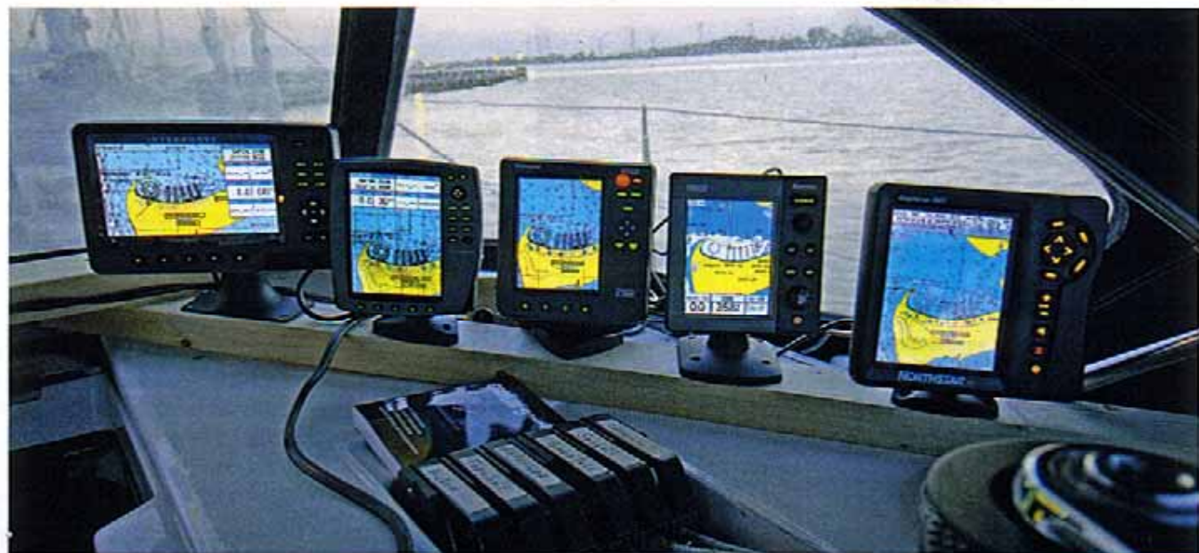
Fünf Testgeräte unter der Sprayhood. Die integrierten GPS-Antennen hatten damit kein Problem, sie funktionierten sogar im Schiff
