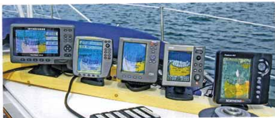
In der prallen Sonne zeigen sich schnell die Unterschiede: Sind die Flüssigkristall-Displays nicht entspiegelt, sieht der Benutzer mehr von der Umwelt als von der Seekarte
